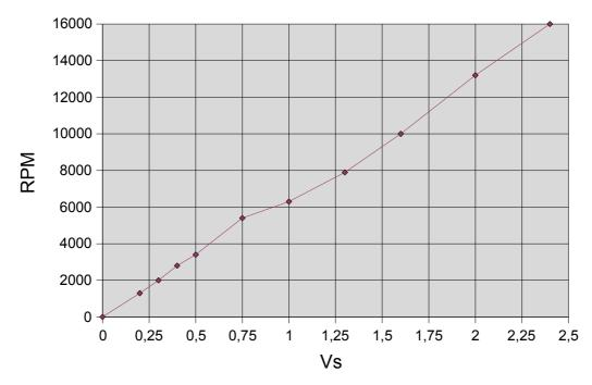
Le rapport mesuré entre la vitesse de rotation et la tension aux bornes du moteur est de *0,152 mV par rpm*. La théorie nous donnait *0,214 mV/rpm*. La mesure était nécessaire.
