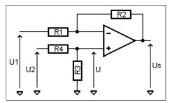
Ce montage permet d'obtenir une tension US fonction de la différence (U2-U1):
