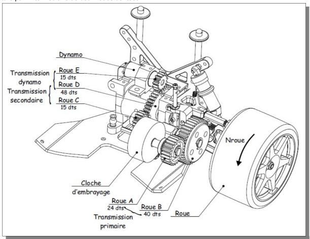
Les calculs permettant de déterminer le rapport entre la vitesse de la voiture et la vitesse de rotation du moteur sont les suivants :
