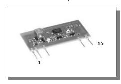
Ce module comporte une antenne intégrée et permet de moduler un signal numérique (suite de '0' et de '1') en ASK (Amplitude Shift Key).
