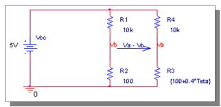
Une simulation donne la valeur de la tension Va – Vb en fonction de la température (Teta) :
