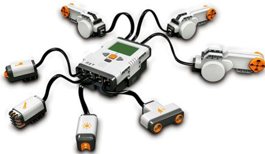
Fig.2 : La brique NXT possède 4 ports d'entrée, 3 ports de sortie, un écran LCD 100x64 et un haut-parleur
