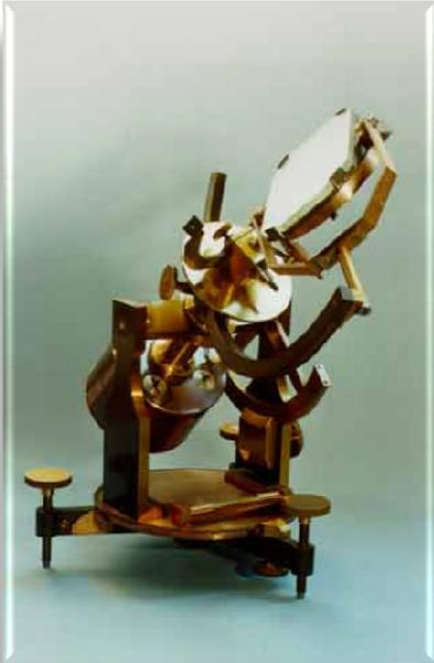
Créé au XVIII<sup>e</sup> siècle, bien qu'il n'en soit pas l'inventeur, la plus ancienne mention de l'héliostat se trouve dans un livre datant de 1742 du physicien néerlandais Willem Jacob 's Gravesande. La rotation du miroir de l'héliostat est assuré par un mécanisme d'horlogerie.
